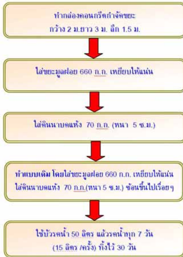
ภาพที่ 45 : ขั้นตอนการผลิตปุ๋ยหมักด้วยเทคโนโลยีกล่องคอนกรีตกำจัดขยะ
